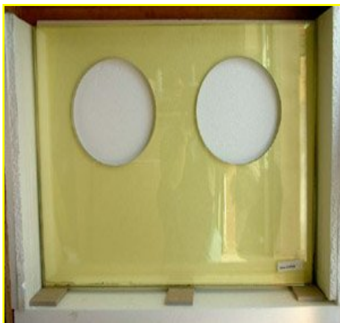
Figura 5. Vidros especiais, usados em instalações nucleares, para proteção contra radiação [8].
