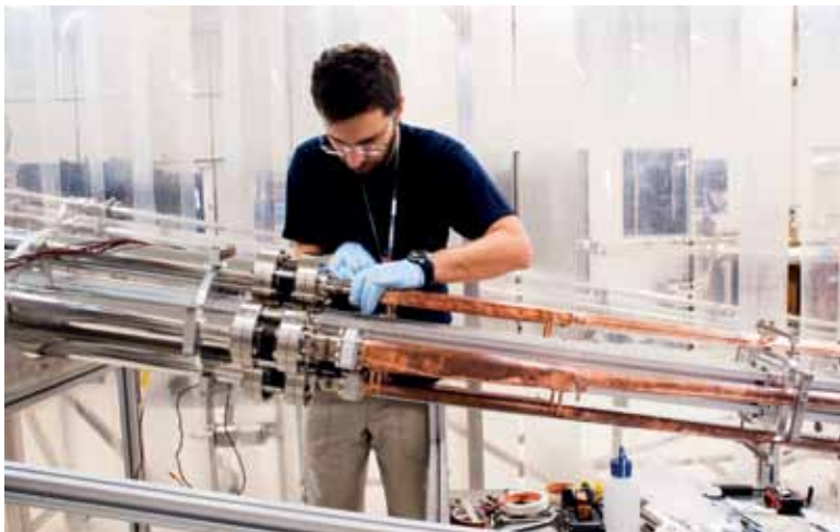
O engenheiro Rafael Seraphim realiza teste do sistema de vácuo das câmaras que conduzirão os elétrons. Ao lado, magnetos quadrupolos, um dos componentes do anel de armazenamento
