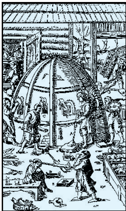
Figura 2: Ilustração de um forno para a fabricação de vidro segundo a Georgius Agricola's De Re Metallica (1556); (a) tubo soprador de vidro; (b) janela pequena móvel; (c) janela por onde era retirado o vidro; (d) pinça e (e) moldes através dos quais as formas das peças eram produzidas.
