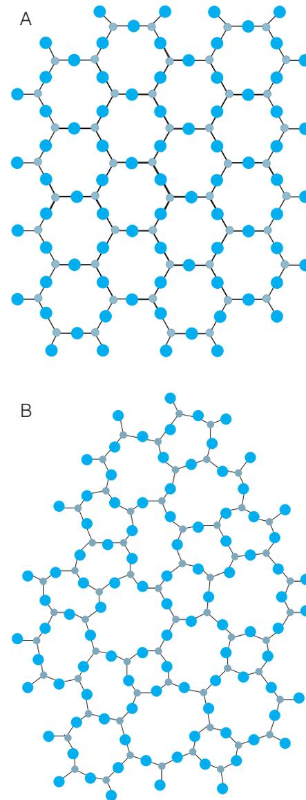
Figura 3: Representação bidimensional: (a) do arranjo cristalino simétrico e periódico de um cristal de composição  $A_2O_3$ ; (b) representação da rede do vidro do mesmo composto, na qual fica caracterizada a ausência de simetria e periodicidade.
