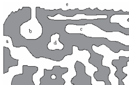
Figura 1. Seção ilustrativa de um sólido poroso com representação dos diferentes tipos de poro: (a), (b), (c) abertos, sendo (b) gargalo de garrafa, (c) cilíndrico; (d) fechado; (e) rugosidade da superfície
