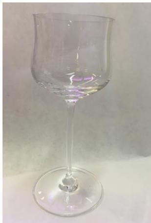
**Taça confeccionada com vidro de composição  $\text{Nb}_2\text{O}_5\text{-SiO}_2\text{-B}_2\text{O}_3\text{-Na}_2\text{O}$  desenvolvido no Laboratório de Química do Estado Sólido (LQES).**
